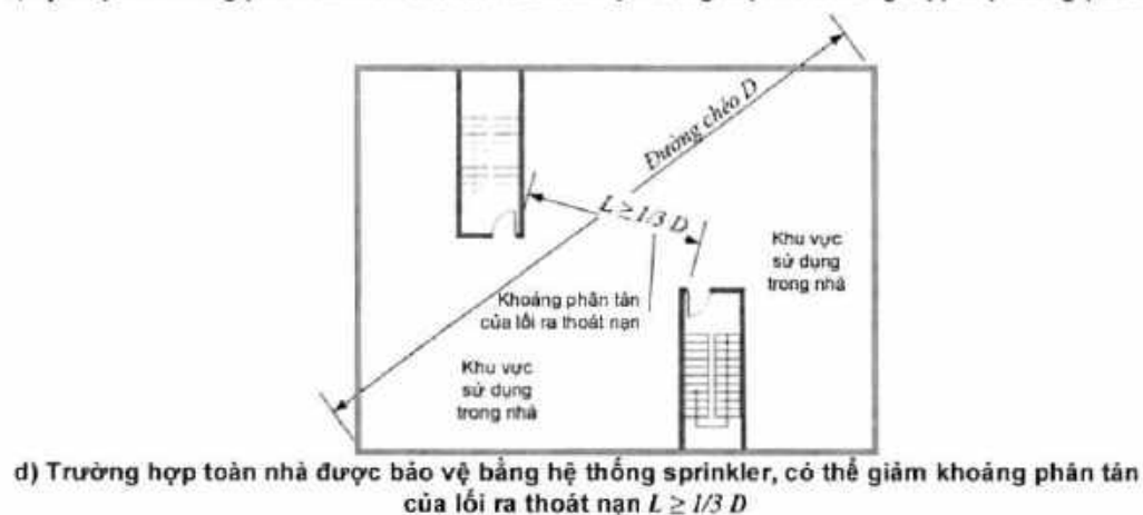
Hình I.4 – Nguyên tắc nửa đường chéo mặt bằng khi bố trí phân tán các lối ra thoát nạn
