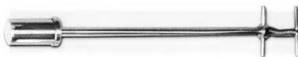
Hình 2. Tuýp lấy mẫu chế phẩm lỏng và chế phẩm bôi ngoài da
