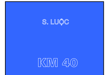
Hình 76: Báo hiệu báo cây số đường thủy nội địa (C4.11)
