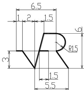
**1. Mẫu ấn chỉ:** Đóng chìm trên vật liệu, máy móc, các trang thiết bị lắp đặt trên tàu được đăng kiểm, kiểm định.
