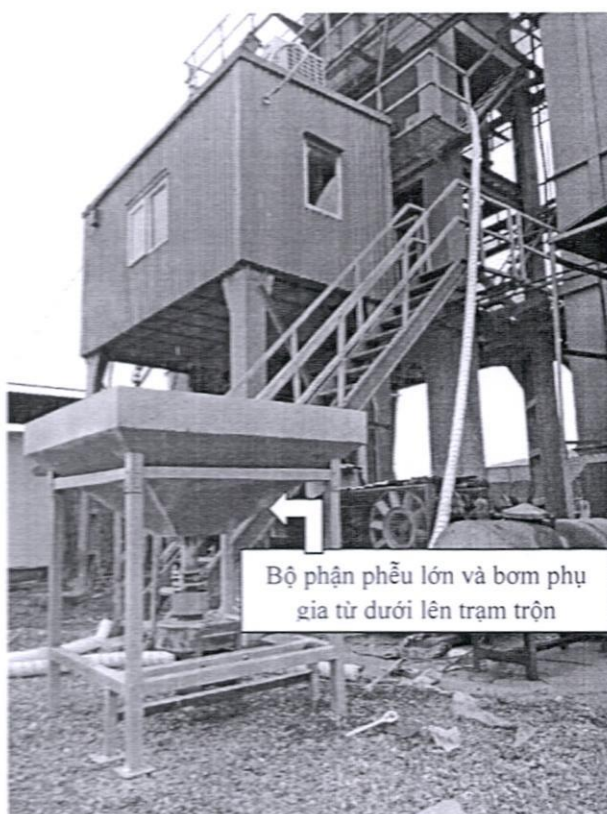
Hình 1 : Sơ đồ minh họa vị trí cấp phụ gia CeraChip tại trạm trộn
